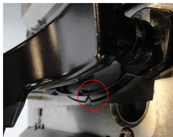
Links: SIGMASOFT simuliert den Verzug des Kunststoffteils nach der Entformung. Rechts: Durch die Praxis bestätigtes Simulationsergebnis des Verzugs.
