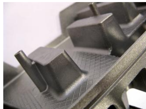
Abb.2: Materialanhäufung: Im Bereich der Kühlbänke erreichen die ansonsten äusserst dünnwandigen Gehäuse Wanddicken von 20 mm und mehr
